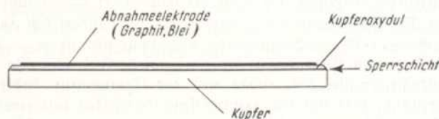
Abb. 61. Aufbau des Trockengleichrichters
