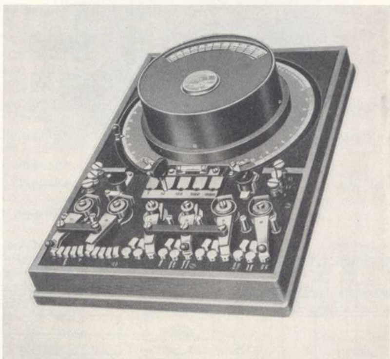
Abb. 31. Universalmeßinstrument. Grundplatte 300 × 435 mm Der Nullkloß (siehe Abb. 32) fehlt hier
