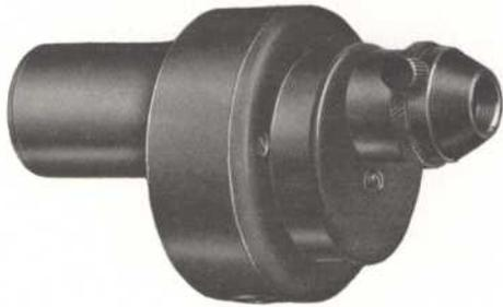
Bild 1. Ardometer (Ansicht).
