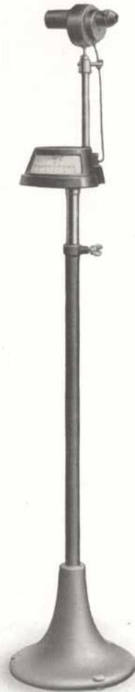
Bild 15. Tragbares Ardometer mit Kegelprofilinstrument auf Eisenstativ.
