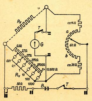
gedrückt. Bei Linksausschlag des Galvanometers ist die Drehskala nach rechts, bei Rechtsausschlag nach links zu drehen, bis das Galvanometer auf Null zeigt. Wenn keine Nullstellung erreicht werden kann, ist ein anderer Meßbereich zu stöpseln. Eine besonders genaue Einstellung auf den Nullpunkt erreicht man durch rythmische Bewegung der Taste im Takt der Zeigerschwingungen. Die Ablesung der Drehskala, multipliziert mit dem Meßbereichfaktor ergibt
