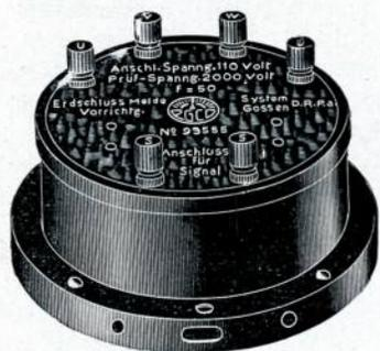
Die Erdschlußmeldevorrichtung Type EM wird in einem schwarz emailliertem Blechgehäuse auf Grundsockel in 2 Größen ausgeführt (siehe Maßzeichnung Seite 62). An Type EM 3 mit Sockeldurchmesser von 195 mm kann nur eine Hupe, an Type EM 4 mit Sockeldurchmesser von 225 mm können drei Hupen angeschlossen werden.
