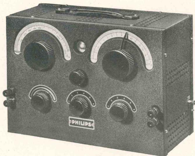
Der tragbare „Philips“ NF-Schwebungs-Oszillator GM 2304 eignet sich für alle in der Praxis vorkommenden Messungen im **Frequenzbereich** von **15 bis 15000 Hz**. Das Gerät läßt sich ebenfalls vorzüglich in Kombination mit den anderen „Philips“ Meßgeräten verwenden, z. B. zur Synchronisierung der Kippfrequenz der „Philips“ Kathodenstrahl-Oszillographen GM 3152 und GM 3153 (s. Seite 4 und 8) oder zur NF-Speisung des Brückenteiles der „Philips“ Universal-Meßbrücke GM 4140 (s. Seite 16) usw.
