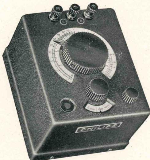
Dieses bereits tausendfach bewährte **Präzisions-Wechselstrommeßgerät** zur direkten Messung von Widerständen und Kapazitäten zeichnet sich besonders **durch kleine Abmessungen, geringes Gewicht**, äußerst niedrige Meßspannung, sehr hohe Empfindlichkeit, höchste Zuverlässigkeit, universelle Verwendbarkeit und leichte Handhabung aus.
