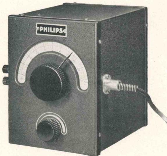
Der „Philips“ Frequenzmodulator GM 2881 eignet sich vorzüglich zur Sichtbarmachung der Abstimmkurve von Rundfunkempfangsgeräten und HF-Verstärkern. Er wird vorzugsweise in Kombination mit den „Philips“ Kathodenstrahl-Oszillographen GM 3152 oder GM 3153 (s. Seite 4 und 8) und einem handelsüblichen Meßsender bzw. Empfängerprüfgenerator verwendet.
