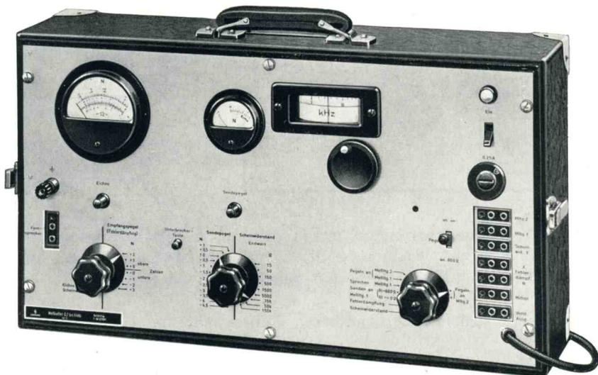
z. B. der Anschluß von Gleichstrom führenden Leitungen (in Bezirks- und Ortsnetzen) ohne Beeinträchtigung der Meßergebnisse oder Beschädigung der Meßschaltung möglich, und der Betriebsschalter hat — zur Vereinfachung der Messungen an Leitungen — besondere Schaltstellungen zum Fernsprechen und für rasches Wechseln, beispielsweise zwischen zwei zu messenden Leitungen.
