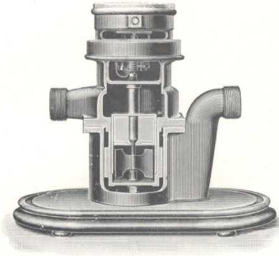
Diese Konstruktion Siemens-Oesten bezweckt, dem Querschnitt der Antriebskanäle entsprechend, die größeren oder geringeren stündlichen Durchflußmengen zu vergrößern bzw. zu verringern. Dies wird durch eine in den Grundbecher genau eingepaßte selbsttätige Schütze erreicht, die bei geringen Durchflußmengen die Kanäle teilweise verdeckt, bei größeren aber durch den Wasserdruck gehoben die Kanäle weiter öffnet. Bei geringeren Durchflußmengen fällt sie durch ihr Eigengewicht wieder zurück.
