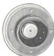
Die Kontakteinrichtung des Beutel-Mikrophons besteht aus einem, an einer Aluminiummembran befestigten Beutel aus Seidenstoff, der die Kohlenkörner enthält und beiderseits durch je ein Kohlenplättchen abgeschlossen ist. Die Regulierung erfolgt durch eine Spiralfeder, die durch eine Stellschraube von außen eingestellt werden kann.
