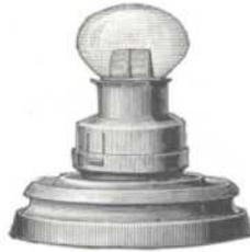
Die Sicherung entspricht in ihrer Bauart einer Glühlampe. Ein knopfförmiger Glaskörper enthält den Bleistreifen, der über einer Glimmerplatte gegabelt ist und an die Kontakte angeschlossen wird.
