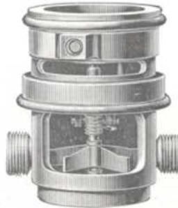
Der Flügelrad-Wassermesser für kleine Haushaltungen beruht auf dem gleichen Prinzip wie der vorbeschriebene, nur trifft das Wasser in ungeteiltem Strahl auf das Schaufelrad, wobei sich als Nachteil die einseitige Abnutzung der Schaufellagerstellen ergibt.
