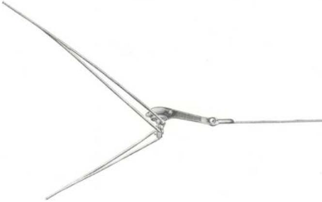
Bei elektrisch betriebenen Straßenbahnen mit Oberleitung muß der Fahrdraht in den Kurven polygonartig geführt werden. Damit der Stromabnehmerbügel nicht an den Querdraht anschlägt, ist bei dieser seit 1890 von Siemens & Halske verwendeten Anordnung zum Fahrdraht ein darüber liegender Beidraht angeordnet worden. Der
