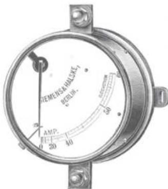
Nach demselben Prinzip wie bei dem Spannungszeiger Nr. 103 wurden unter entsprechender Gestaltung der Wicklung auch Stromzeiger gebaut. Später erfuhr die Konstruktion eine Reihe von Abänderungen. Man benutzte nur noch ein Eisenstäbchen und gestaltete die Übertragung seiner Bewegung auf den Zeiger einfacher.
