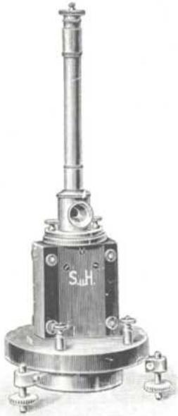
Das Instrument ist mit feststehendem Magnetsystem und beweglicher, an Metallfäden hängender Spule ausgerüstet. Die Ablenkungen des mit der Spule verbundenen Spiegels sind infolge eines vollständig homogenen Magnetfeldes in weiten Grenzen proportional dem durch die Spule gesandten Strome und werden mittels besonderer Ablesevorrichtungen (Meßlaternen) beobachtet.
