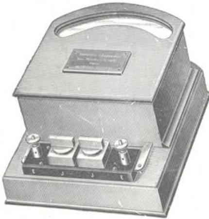
Dieses Instrument ist nach rein elektrodynamometrischem Prinzip gebaut; es besitzt direkte Zeigerablesung, proportionale Skala und zeigt sowohl bei Gleichstrom, als auch bei Wechselstrom von beliebiger praktisch vorkommender Frequenz, Stromkurvenform, Phasenverschiebung und Spannung bei geringem Energieverbrauch die Leistung richtig an. Eine nahezu aperiodische Einstellung des Zeigers wird mittels einer durch D. R. P. geschützten Luftdämpfung erreicht.
