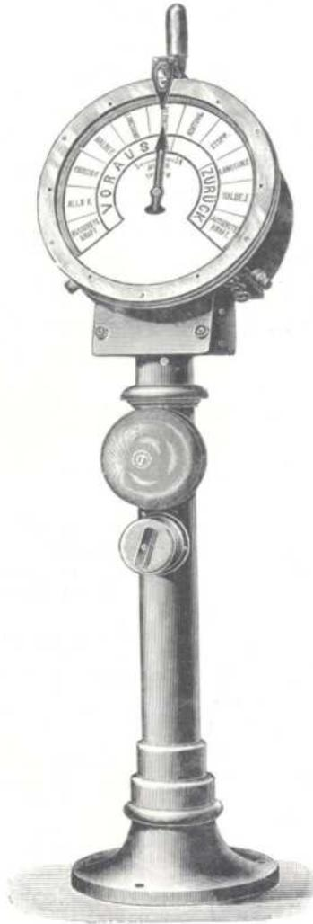
Das Prinzip dieses Apparates ist das gleiche wie bei dem vorstehend beschriebenen, nur mit dem Unterschied, daß das Handrad durch einen Hebel mit Zeiger ersetzt ist.
