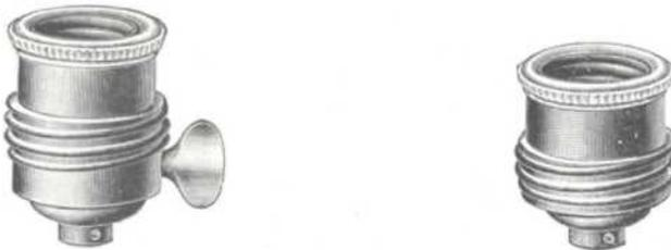
Diese Fassungen entsprechen den Vorschriften des Verbandes Deutscher Elektrotechniker; sie sind für 250 Volt verwendbar und unterscheiden sich dadurch von den älteren Fassungen, daß ihre Montage äußerst einfach ist, die Anschlußklemmen weit voneinander und in großer Entfernung von dem äußeren Mantel liegen. Ebenso ist auch die Entfernung des Mittelkontaktes von dem Gewindemantel eine große. Der Griff des Ausschalters besteht aus Isoliermaterial.
