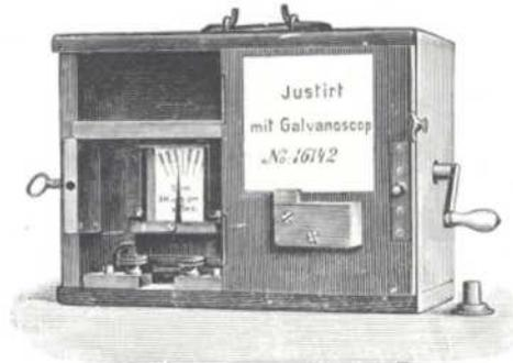
Der Apparat besteht aus einem kleinen Magnetinduktor, der durch eine Handkurbel in Tätigkeit gesetzt wird, und einem kleinen Vertikal-Galvanoskop, dessen Zeiger vor einer nach Widerstandseinheiten geteilten Skala spielt. Es war dies s. Zt. das erste Meßinstrument für Monteure zur Prüfung von Leitungen auf Isolation und Erdschluß.
