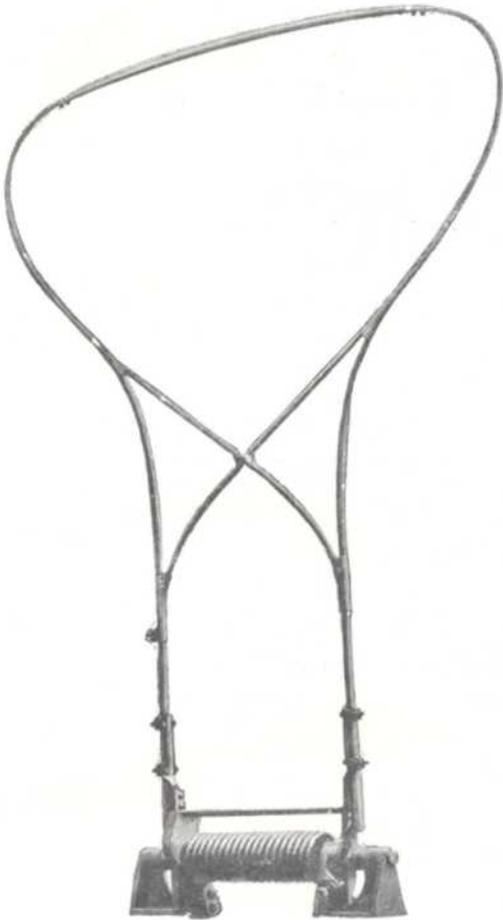
Der Bügel-Stromabnehmer, der von Siemens & Halske für elektrische Bahnen seit 1887 verwendet wird, hat seit 1891 die in nebenstehender Figur dargestellte und dem Museum überlassene Ausführung erhalten, die unter andern bei den elektrischen Straßenbahnen in Dresden Verwendung gefunden hat.
