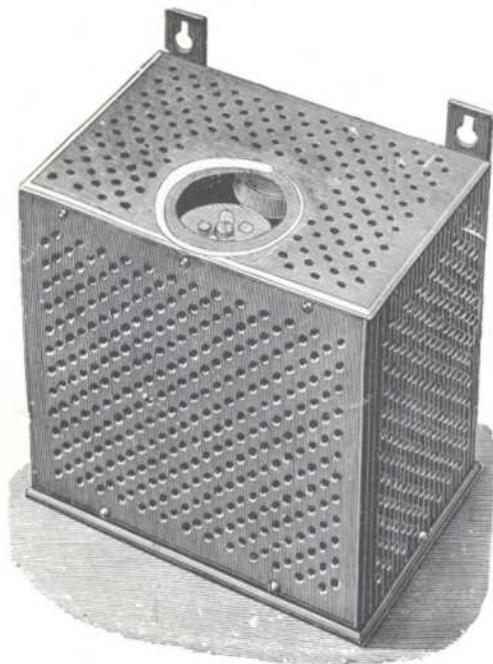
Die Bogenlampenwiderstände bestehen aus mehreren Zylindern, auf die in schraubenförmige Nuten Drähte von passenden Abmessungen gewickelt sind. Der eine dieser Zylinder ist mit Kontaktknöpfen und einer kleinen Metallbrücke versehen, um eine Regulierung des Widerstandes bewirken zu können.
