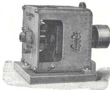
Dieses kleinste Modell der A-Maschinen ist zweipolig. Das Elektromagnetsystem ist aus gestanzten Blechen zusammengesetzt, die in das gußeiserne Gehäuse eingelegt werden.
