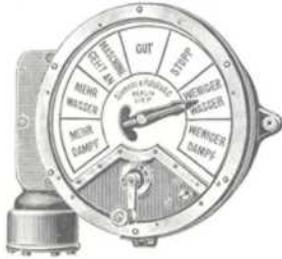
Das Prinzip des Apparates beruht ebenfalls auf dem System des Sechsrollenmotors (siehe Nr. 42). Die Schaltungsweise dieser Apparate ist derartig, daß eine beliebige Anzahl untereinander verbunden werden kann, und man von jedem Apparat die anderen zu betätigen vermag, also jeder Apparat als Geber und Empfänger wirkt.
