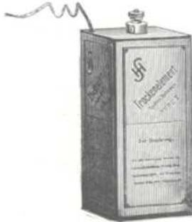
Das Hellesen-Element ist ein Trockenelement, dessen einen Pol ein mit Braunsteinmasse umpreßter Kohlenstab, dessen anderen ein Zinkbecher bildet. Als Elektrolyt dient eine Salmiaklösung, die mittels geeigneter Zusätze eine weiche Masse darstellt. Das ganze wird von einem Isolationsbecher umschlossen.
