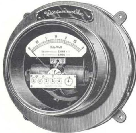
Dieser Zähler beruht auf demselben Prinzip, wie der Wattstundenzähler Nr. 129, gestattet aber eine wesentlich genauere und häufigere Registrierung. Das Instrument gehört dem Deprez-d'Arsonval-Typus an, bei dem die Zeigerausschläge den gemessenen Stromstärken bzw. Energiemengen proportional sind.
