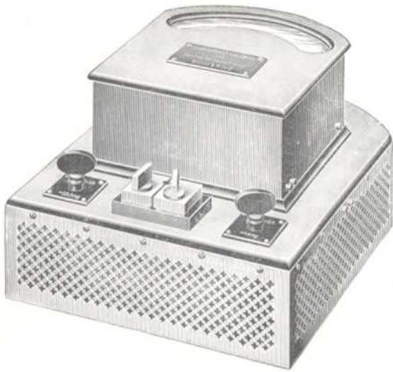
Das seit 1900 gebaute Instrument ist ebenfalls nach rein elektrodynamometrischem Prinzip gebaut, hat direkte Zeigerablesung und aperiodische Einstellung des Zeigers. Durch geeignete Anordnung der Spulen, die in Parallelschaltung liegen, ist statt einer quadratischen Skala eine auf etwa dreiviertel ihrer Länge möglichst proportionale erreicht.
