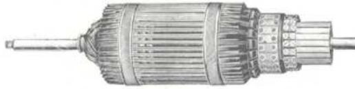
Dieses Muster der ersten Ausführung eines Trommelankers ist stufenförmig ausgeführt, um die innere Anordnung sichtbar zu machen. Auf die stählerne Welle ist ein Holzzylinder aufgeschoben, auf den einige Lagen Eisendraht gewickelt sind. In achsialer Richtung ist darüber der besponnene Kupferdraht gelegt.
