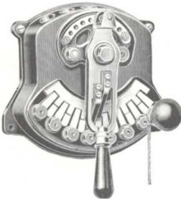
Auf einer gußeisernen Grundplatte sind die mit den Klemmen für die Zuleitungen zu den einzelnen Zellen versehenen Kontaktplatten im Kreisbogen montiert. Zwischen je zwei Kontaktplatten befindet sich ein Blindkontakt, außerdem läuft parallel zu der Kontaktplattenreihe noch eine Gleitschiene, an die das eine Ende der an der Unterseite der Grundplatte
