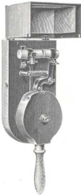
Dieser für Motoren von nicht mehr als 1 PS und Spannungen bis 125 Volt verwendete Anlasser besteht aus einem Stromwender, der mit einem Kohlen-Ausschalter vereinigt ist. Die starken Öffnungsfunken werden dadurch von den Metallkontakten nach den Kohlenkontakten verlegt und so unschädlich gemacht.
