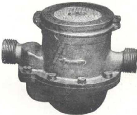
Dieser Messer registriert das Volumen des durchfließenden Wassers, indem in einer Meßkammer eine konische Hartgummischeibe durch das Wasser in eigentümlicher Weise umhergewälzt wird. Diese Bewegung wird auf ein unter Wasser befindliches Zählwerk übertragen. Der Apparat hat den Vorzug großer Genauigkeit und Empfindlichkeit.
