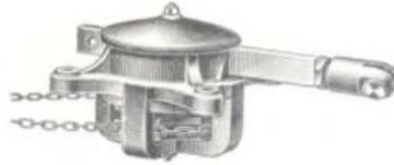
Das Modell stellt in  $\frac{1}{4}$  natürlicher Größe einen Weichenverschlußriegel dar, der mittels Drahtzuges betätigt wird, um die Weiche in der ihr erteilten Stellung zu verriegeln.
