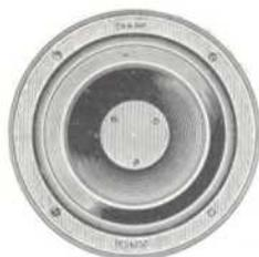
Die Einrichtung dieses Mikrophons ist dieselbe wie die des Präzisions-Mikrophons Nr. 31, nur mit dem Unterschiede, daß statt des einen schweren Kohlenkegels drei solche von geringerem Gewicht vorhanden sind. Die Regulierung erfolgt durch eine Spiraldruckfeder.
