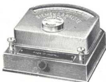
Das Instrument, das dem Deprez-d'Arsonval-Typus angehört, ist mit Voltskala und Ohmskala versehen. Besonders hervorzuheben ist die magnetische Nebenschließung, die auf den Vorschlag von Uppenborn angebracht ist und dazu dient, die Widerstandsskala auch für Meßspannungen, die von der normalen um 5% abweichen, direkt ablesbar zu machen.
