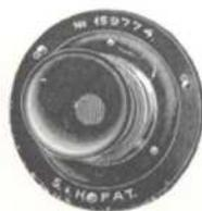
Das Kohlenkörner-Mikrophon hat eine Kontaktvorrichtung in Gestalt einer auswechselbaren Sprechkapsel mit einer Kohlenmembran, an der ein Filzring mit Kohlenboden befestigt ist. Zwischen Membran und Kohlenboden sind die Kohlenkörner gelagert. Die Stellschraube befindet sich an der hinteren Seite der Sprechkapsel.
