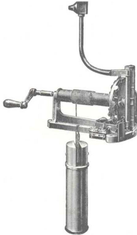
Das Spindel-Läutewerk wird durch ein Gewicht angetrieben. Es besitzt nur ein mit Knaggen versehenes Rad und eine Spindel, die wie bei einer Schwarzwälder Uhr während des Ganges durch das Knaggenrad hin- und hergeworfen wird. Die Spindel trägt oben den pendelartig ausgebildeten Hammer, der beim Hin- und Hergang jedesmal gegen die Glocke schlägt.
