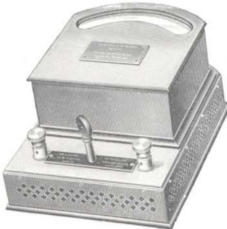
Dieses Instrument hat direkte Zeigerablesung und ist nach rein elektrodynamometrischem Prinzip gebaut. Es besitzt ähnliche Vorzüge wie das Präzisions-Wattmeter (Nr. 122), hat jedoch keine vollkommen proportionale Skala. Durch geeignete Anordnung der Spulen ist indessen für den in Betracht kommenden Meßbereich möglichste Proportionalität der Skalenteile erreicht. Die Zeigereinstellung erfolgt ebenfalls aperiodisch.
