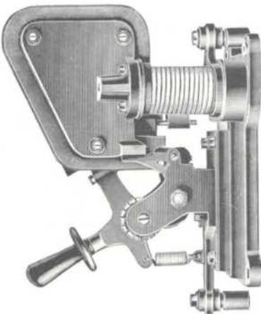
Auf einer Grundplatte ist der zweiarmige Schalthebel drehbar montiert, dessen einer Arm durch eine Schraubensfeder in die Ausschaltstellung gezogen wird, während der andere Arm einen Messerkontakt trägt, an dem der aus einer Kupferschleife bestehende Hilfsschalterkontakt befestigt ist. Am oberen Teil der Grundplatte befindet sich die mit Polplatten versehene, wirksame Elektromagnetspule, zwischen den Polplatten der Haupt- und Nebenkontakt.
