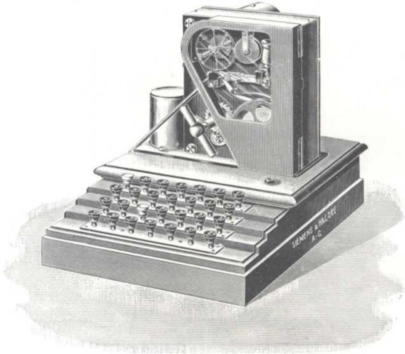
Dieser Telegraphenapparat ist eine Vereinigung von Geber und Empfänger des Börsendruckers (siehe Nr. 15) zu einem einzigen Apparat. Ähnlich wie beim Fernsprecher kann auch beim Ferndrucker durch eine Zentrale eine Anzahl von Abonnenten zum direkten telegraphischen Verkehr miteinander in Verbindung gesetzt werden. Ebenso können von der Ferndrucker-Zentrale gleichzeitig alle oder ein Teil der Abonnenten gleichlautende Nachrichten erhalten.
