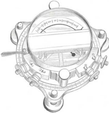
Das Instrument besitzt eine Magnetnadel mit Zeiger, der über einer Skala schwingt, und eine in zwei Abteilungen getrennte Wicklung; die Abteilungen können beliebig eingeschaltet werden. Der Galvanometerrahmen ist in einem besonderen Gehäuse horizontal drehbar angeordnet und seine Drehung kann an einem äußeren Teilkreise abgelesen werden. Der Sinus des Drehungswinkels ist der Stromstärke proportional.
