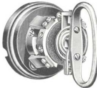
Bei diesen Schaltern wird durch Drehen des Griffes ein Spannwerk gespannt und im letzten Moment ausgelöst, so daß dann die Schaltbrücke kräftig in die Ausschaltbezw. Einschalt-Stellung springt.
