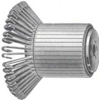
Zu diesem Kommutator sind kupferne Schleifsegmente verwendet, die an beiden Enden dreieckige Einschnitte haben, in welche die doppelkegelförmigen Vorsprünge der Kommutatorbüchse und eines mit vier Schrauben befestigten Spannrings eingreifen. In die Kommutatorsegmente sind auf der dem Anker zugekehrten Seite Kupferblechstreifen eingelassen, deren äußere Enden umgebogen sind und zum Einlöten der Ankerdrahtenden dienen.
