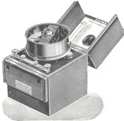
Der für alle Nadel-Galvanoskope für Isolationsmessungen vorbildlich gewordene Isolationsprüfer besteht aus einem Nadel-Galvanoskop und einer Meßbatterie von Trockenelementen. Die Nadel zeigt eine Ablenkung entsprechend der Stärke des durch den Isolationswiderstand fließenden Stromes. Die Skala gibt direkt den Isolationswiderstand an.
