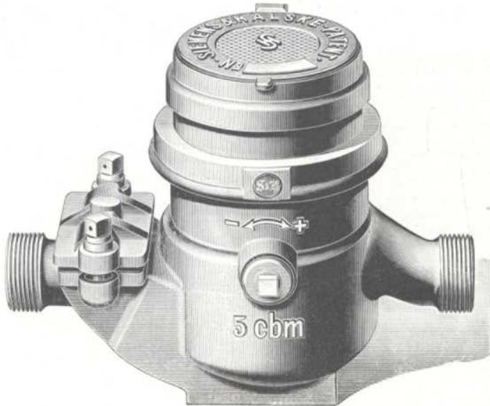
Die Flügelrad-Wassermesser, Modell TN, registrieren vor- und rückwärts, so daß etwa zurückströmendes Wasser zurückgezählt und nur das wirklich aus der Leitung entnommene Wasser angezeigt wird. Ein Ölen des Messers ist durch die Lagerung der Schaufelrad-Achse in Kohlebuchsen überflüssig. Das Sieb ist zur Reinigung von Schmutzablagerungen herausnehmbar angeordnet. Die Leistung beträgt etwa 5,6 cbm pro Stunde bei 10 m Druckhöhe.
