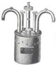
Der Widerstand ist als Brückenwiderstand konstruiert und dient dazu, unbekannte Widerstände bei Vergleichung mit einem Normalwiderstand auf genauesten Wert abzugleichen oder diesen durch Interpolation zu bestimmen. Der Apparat entspricht den Modellen der Physikalisch-Technischen Reichsanstalt und wird seit 1896 gebaut.
