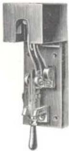
Zur allmählichen Unterbrechung von Stromkreisen, bei denen starke Extrastrome auftreten, wird der Öffnungsfunken zwischen Kohlenkontakten hervorgerufen, nachdem der Kurzschluß, der durch einen Hebelschalter für diese Kohlen gebildet ist, aufgehoben wurde.
