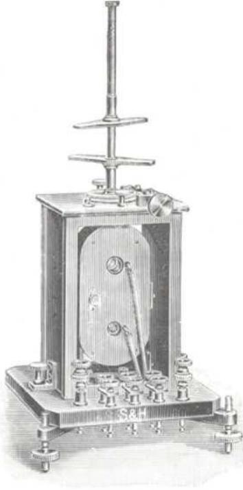
Das Instrument besitzt ein sehr leichtes astatiches Magnetsystem aus Stahllamellen, Glimmerflügel als Luftdämpfung und vier feststehende Spulen, die durch geeignete Klemmenanordnung auf der Grundplatte beliebig hintereinander oder parallel geschaltet werden können. Zwei auf der oberen Gehäuseplatte angebrachte Richtmagnete lassen sich sowohl einzeln an einer Stange von Hand verschieben, als auch durch Mikrometerschraube mit Feinstellung drehen.
