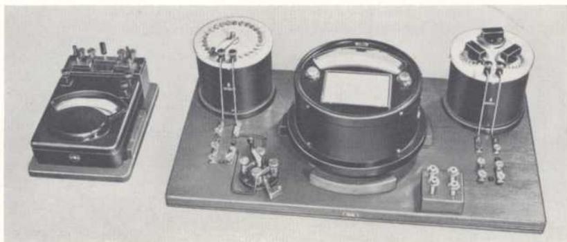
Magnetisierungs-Apparat nach Köpsel mit Zehnom-Instrument und Schaltungsvorrichtung.
